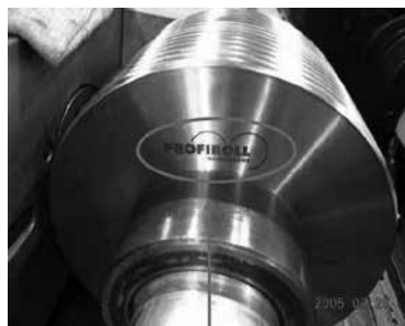
本公司牙輪亦採用德國Bad Düben原廠滾輪，以維持原廠機台穩定性及轉造後品質。
