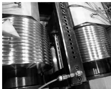
本公司採用最先進德國數值電控滾牙機，轉造製程中，牙輪兩軸油壓缸皆採用伺服油壓補正油壓壓力及定位精度。
